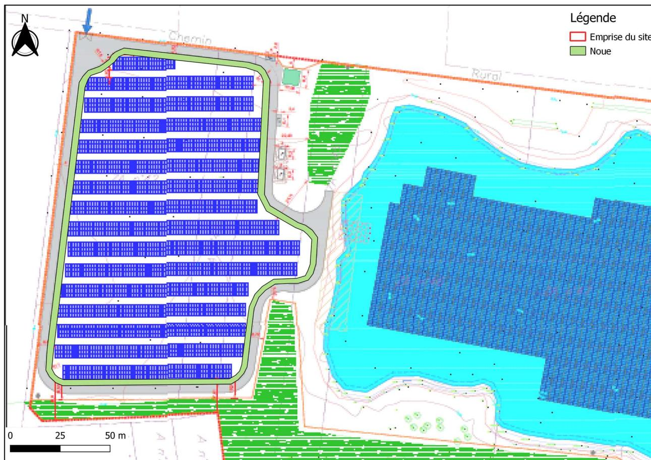
**Figure 25 : Proposition de la noue d'infiltration des eaux pluviales**
